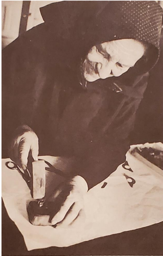
5. A meghajlított rézlemez beütése kalapáccsal. 1974.
